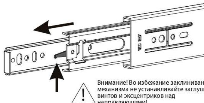
**Схема установки шариковых направляющих.**
