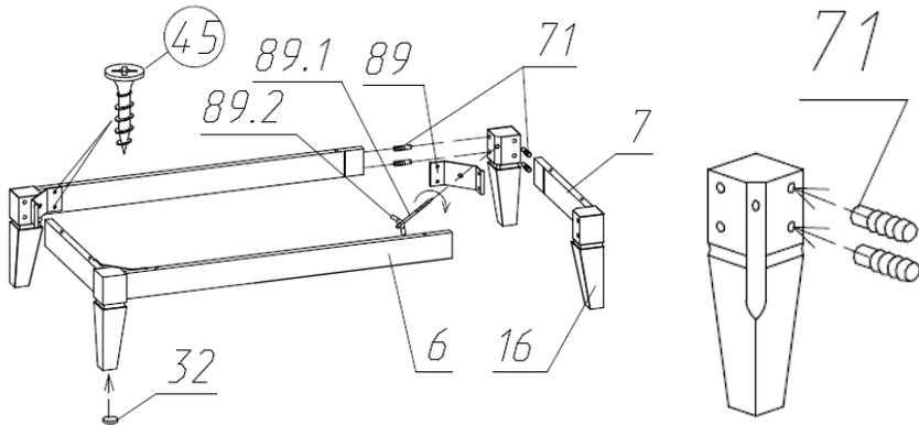
Соединив детали воедино (ножку и планки), вначале закрутите шпильку (поз.89.1), гайку барашек (поз.89.2) затем саморезы (поз.45).
