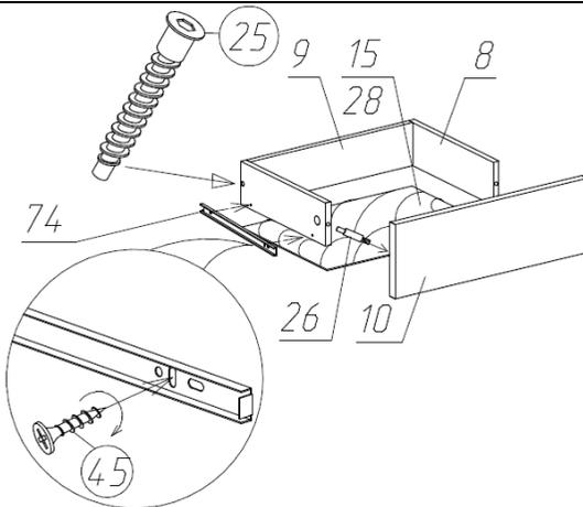
Установка шариковых направляющих (поз.74)
